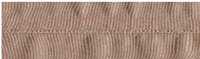
Erkennungsmerkmal: Kräuselung symmetrisch links und rechts der Naht; nach dem Aufschneiden der Stichbrücken verschwinden die Kräuselungen
