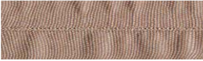
Erkennungsmerkmal: Kräuselung symmetrisch links und rechts der Naht; nach dem Aufschneiden der Stichrücken bleiben die Kräuselungen bestehen
